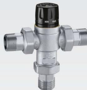
La **VALVOLA MISCELATRICE** termostatica va installata a valle della valvola rompi vuoto. La temperatura dell'acqua sanitaria può essere impostata secondo il valore desiderato, agendo sulla manopola di regolazione nel campo 35-55 °C.
