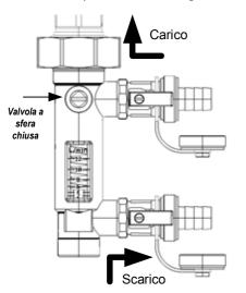
(1) - Operazione di carico dell'impianto: Togliere il tappo alle valvole laterali e inserire il portagomma. Chiudere la valvola a sfera ed aprire le valvole laterali di carico e scarico.
