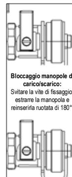
**Bloccaggio manopole di carico/scarico:**
